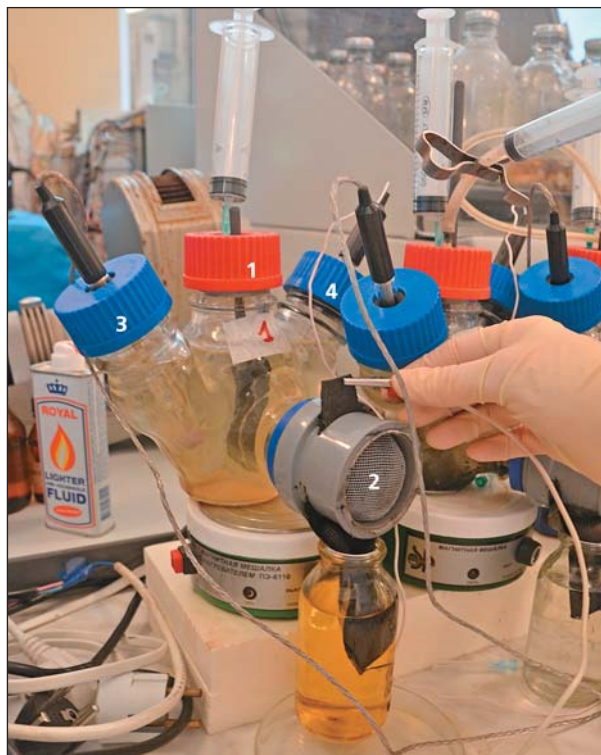
Рис.3. Лабораторный прототип микробного топливного элемента для скрининга и культивирования сообществ и чистых культур электрогенных микроорганизмов: 1 — анод, 2 — катодная камера, 3 — pH-электрод, 4 — электрод сравнения.
