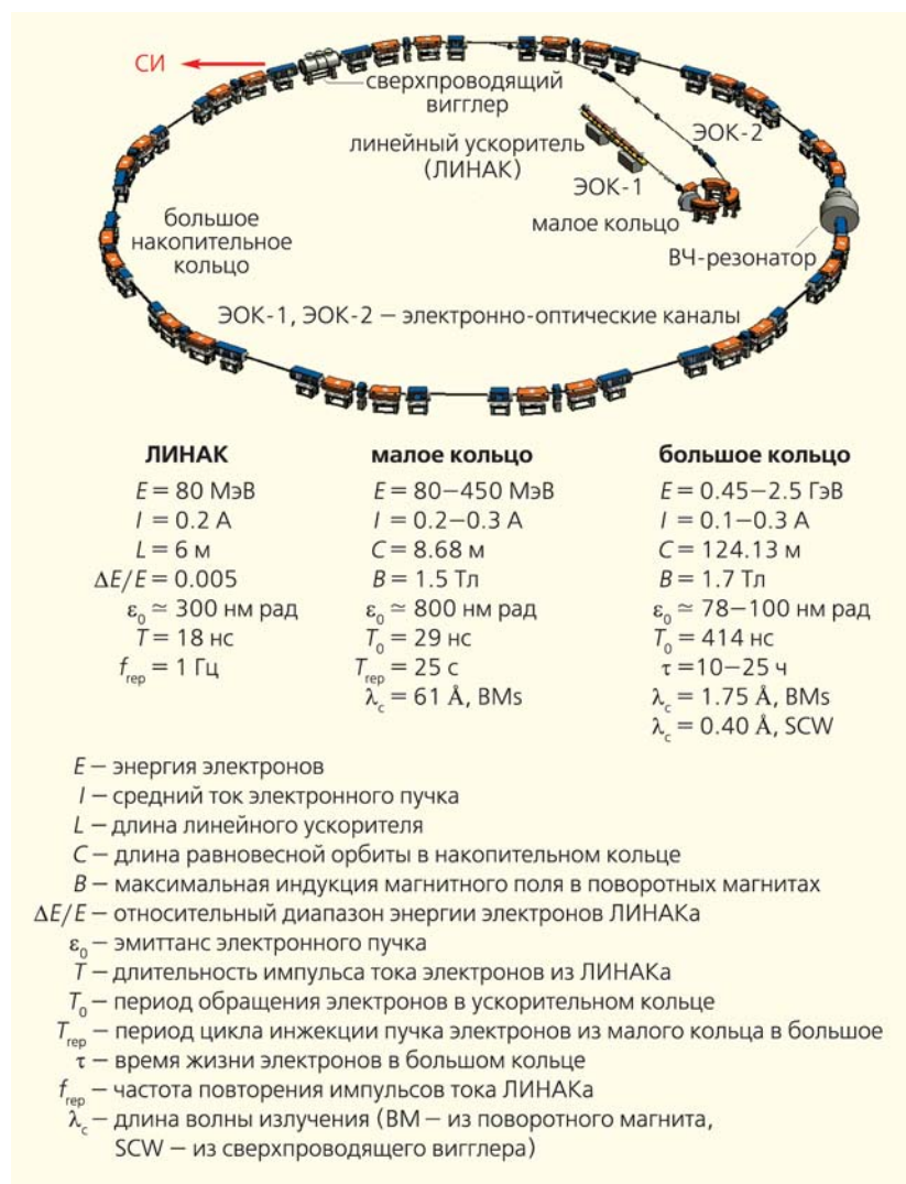
Рис.4. Ускорительно-накопительный комплекс источника СИ.
